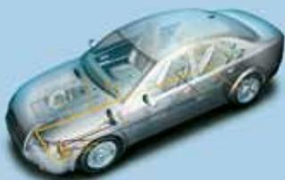
Вырабатываемое главным цилиндром гидравлическое давление подается на колесные тормоза через трубопроводы и шланги. Средой передачи служит тормозная жидкость.
